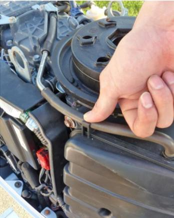
5. Letakkan dengan baik selang breather ke klem kotak silinder
