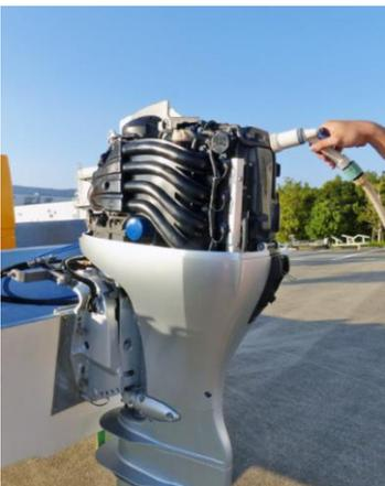
2. Cuci motor tempel dengan air bersih untuk menghilangkan air garam, pasir, lumpur dan lain-lain.
